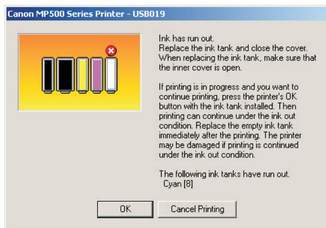
Po zobrazení tohoto okna přerušte tisk, vyjměte zásobník z tiskárny a následně ho opět vložte ho zpět do tiskárny. Po vložení zásobníku se zobrazí následující okna:
